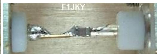
Mes deux réalisations sont loin d'être parfaite , il faudrait encore diminuer les longueur des connections car cela peut engendrer des selfs parasites qui détériorent les performances des deux montages .
